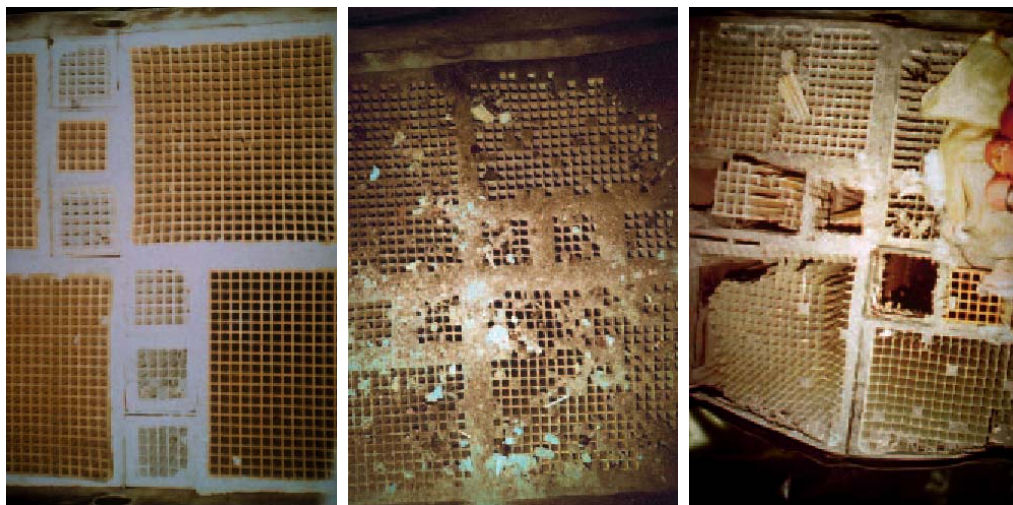
Fig. 3.40. Evoluția procesului de deteriorare a catalizatorului
